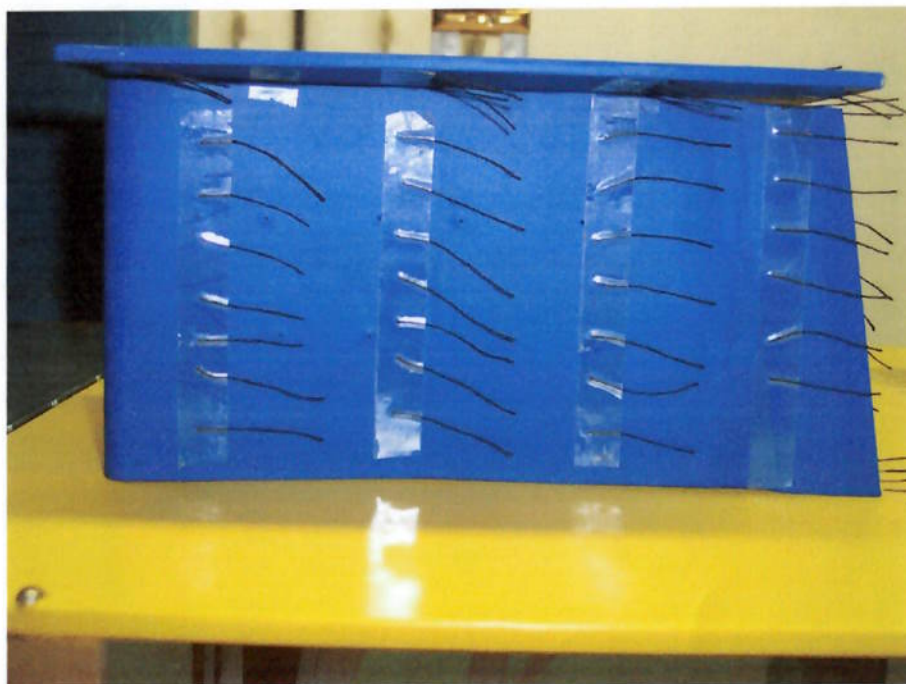
Figura 47 - Visualização do escoamento com tufts: intradorso (asa com endplate, zero graus)
