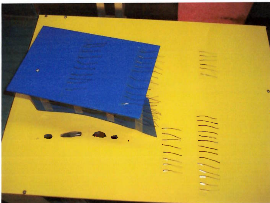
Figura 49 - Visualização do escoamento com tufts (asa com endplate, doze graus)
