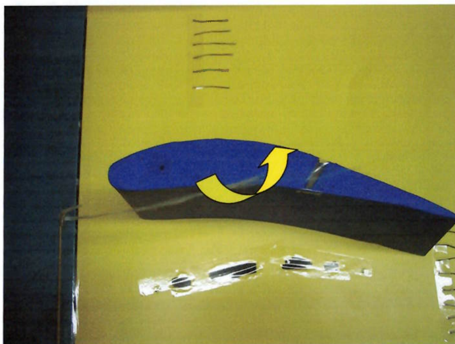
Figura 31 - Visualização do escoamento: vórtice de ponta de asa (asa sem apêndice, doze graus)
