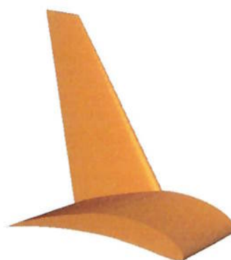
Figura 14 - Posicionamento do winglet na ponta da asa
