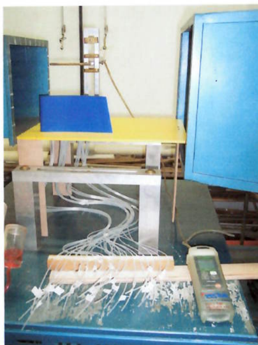
Figura 27 - Montagem final: base de testes com protótipo sem dispositivo na ponta da asa
