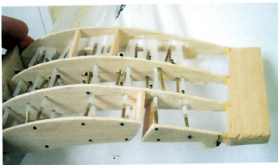
Figura 24 – Fabricação do protótipo: abertura para fixação do endplate e winglet
