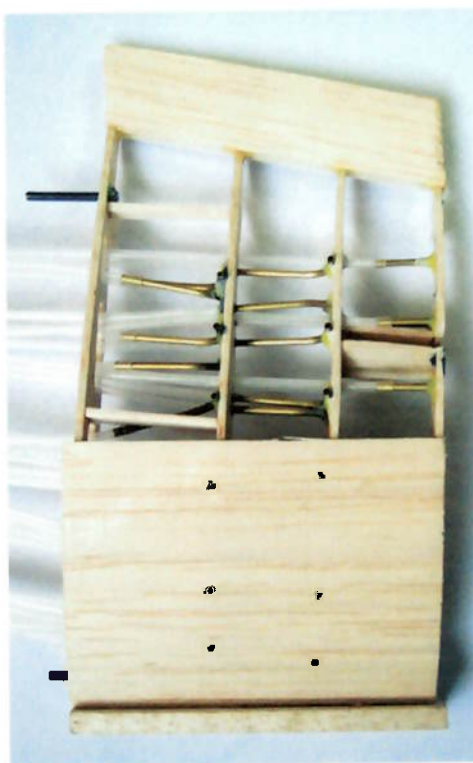
Figura 25 –Fabricação do protótipo: chapeamento da estrutura e parafusos de fixação na base de testes
