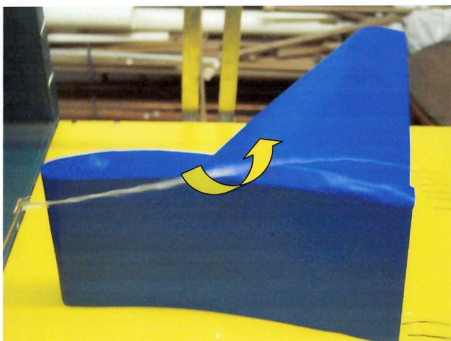
Figura 41 - Visualização do escoamento: escoamento na transição intradorso-winglet (asa com winglet, doze graus)
