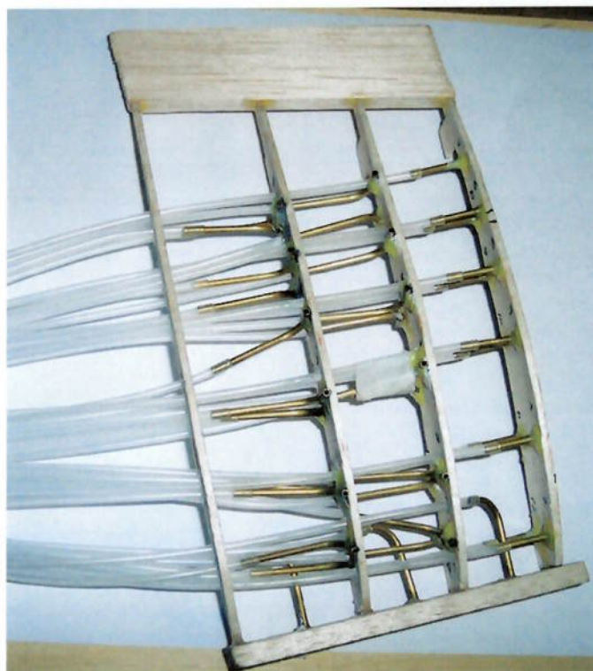
Figura 23 – Fabricação do protótipo: visualização das tomadas de pressão mas sem acabamento final
